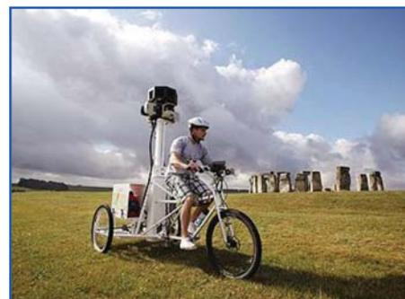
Figura 3. Triciclo de Google Street View. Con una cámara de sensor múltiple permite la creación de espacios inmersivos que insertados en Google Earth ofrecen la sensación de estar virtualmente desplazándose por el mundo real.
